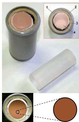
Рис. 6.1. Монокристалл CsI(Tl) в контейнере до \gamma -облучения (бесцветный) и после дозы (окрашенный):
