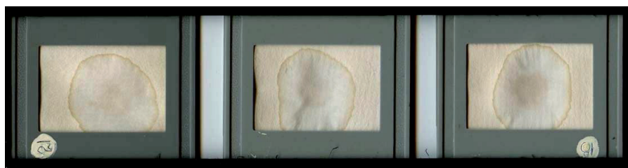
Рис. 5.4. Набор слайд-адапторов с индикаторными тест-бумагами для определения кобальта с пирокатехином.
