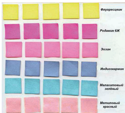
Рис. 6.6. Тестовый стенд с образцами бумаги, пропитанными красителями. Каждый ряд состоит из одинаковых (параллельных) проб.
