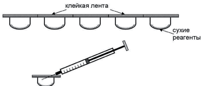
Рис. 5.16. Схема проведения тест-анализа в блистере.
