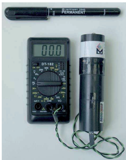
Рис. 7.1. Портативный фотоколориметр "Фототест". Слева – мультиметр, справа – фотоколориметр, сверху – шариковая ручка, облегчающая масштабирование.
