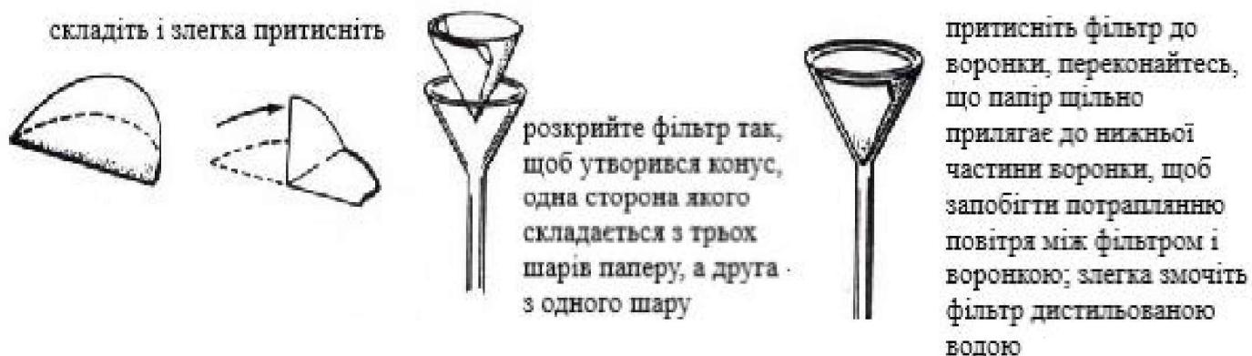
Рис. 1. Схема складання фільтру
